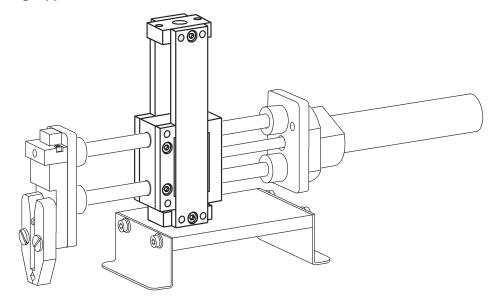
In der Baugruppe 4 wird die Vertikalachse für das Handhabungsgerät V hergestellt. Die Fügetechnik ist der Schwerpunkt dieser Baugruppe.
