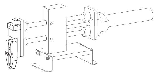
In der Baugruppe 3 wird ein Greifer für das Handhabungsgerät V hergestellt. Ein Schwerpunkt dieser Baugruppe ist die Frästechnik.
